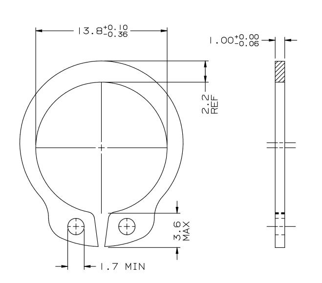
SHAFT DIA.: 15 mm GROOVE DIA.: 14.3 +0:00 mm GROOVE WIDTH.: 1.10 mm MIN
